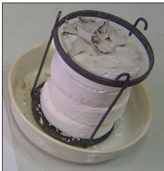
شکل ۱۱: تصویری از یکی از آزمون‌های FR پس از آزمایش. آزمون دچار ریزش کلی یا خردشدگی نشده است. بقایای کاغذ روی سطح قابل مشاهده است.
