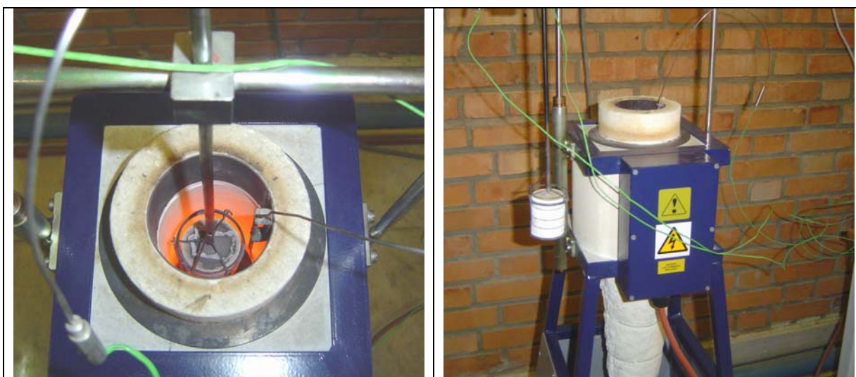
شکل ۱۰: آزمون در داخل کوره در حین آزمون. جمع‌شدگی کاغذ در بالای آزمون قابل مشاهده است.
